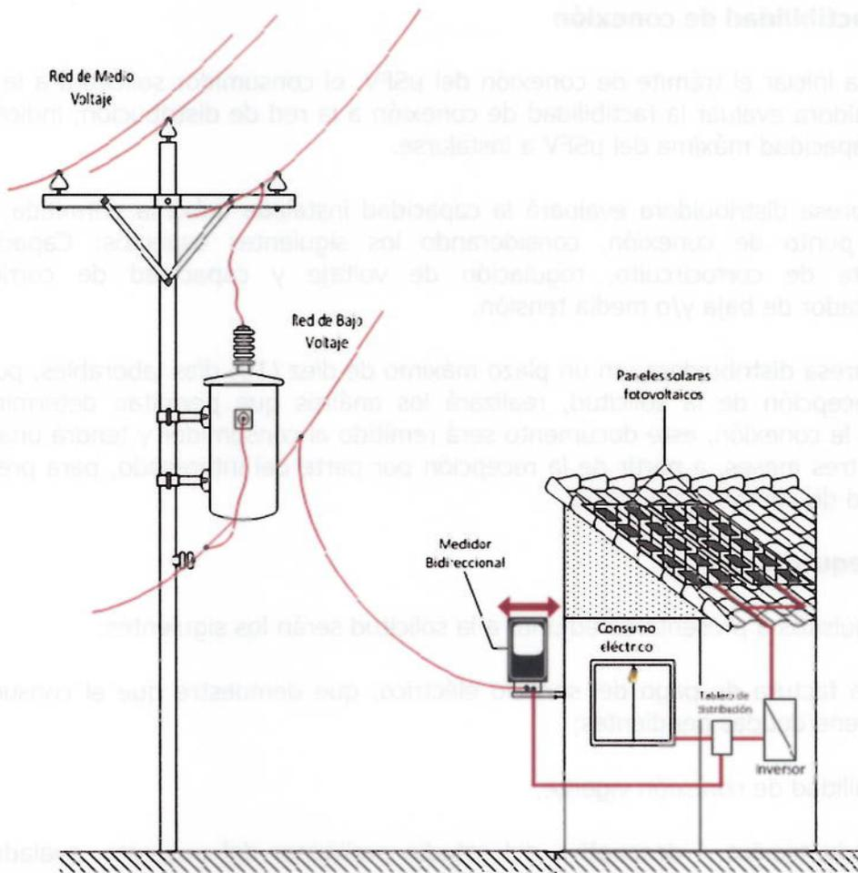
Figura 1. Esquema de instalación del  $\mu$ SFV
